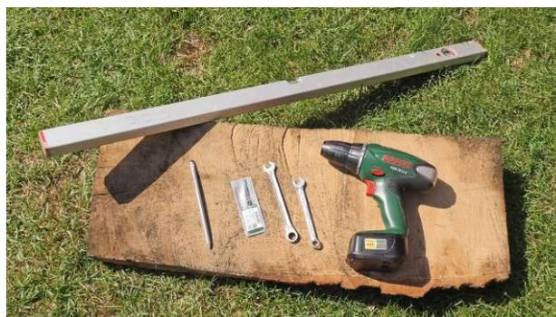
Für die Montage wird ein **Akkuschrauber** mit einem **4,2 mm Metallbohrer** sowie ein **Kreuzschlitzschraubendreher** (PH2) benötigt. Des Weiteren sind **Wasserwaage**, ein **Maßband** und ein **Stift** sowie zwei **10er Gabelschlüssel**, ein **Schlagbohrer** und für das Mauerwerk passende **Dübel und Schrauben** erforderlich.
